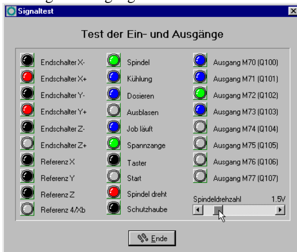
Sonderfunktion SIGNALTEST mit LED-Anzeigen der wichtigsten Eingänge
